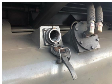
TEM TMH ir ČME serijos lokomotyvo kuro bakas
